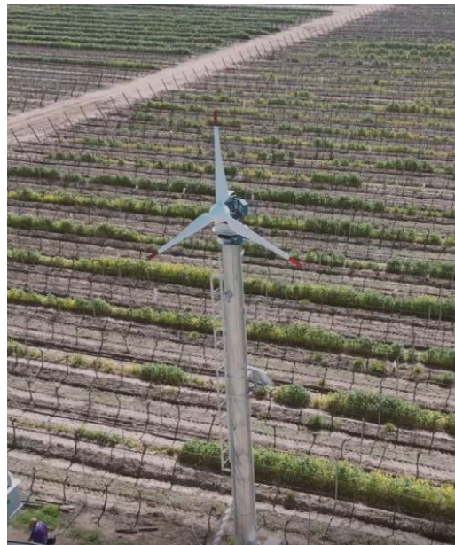
TORRES DE HELADA ELÉCTRICAS
